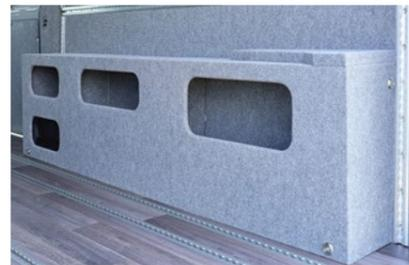
**Radkastenverkleidung rechts, verschiedene Staufächer**
