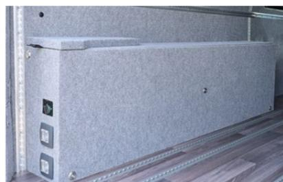
**Radkastenverkleidung links, Staufach für Elektro-Paket**
