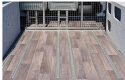
**Airlineschienensystem am Boden, Dach und an Seitenwänden**
